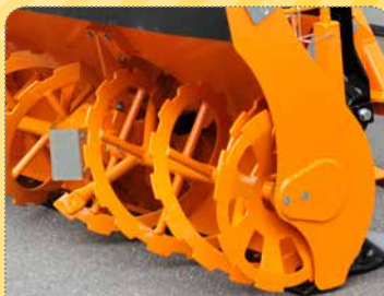
Robuste Fräshaspel mit 400 mm Durchmesser mit Arbeitsbreite 120 bzw. 140 cm
